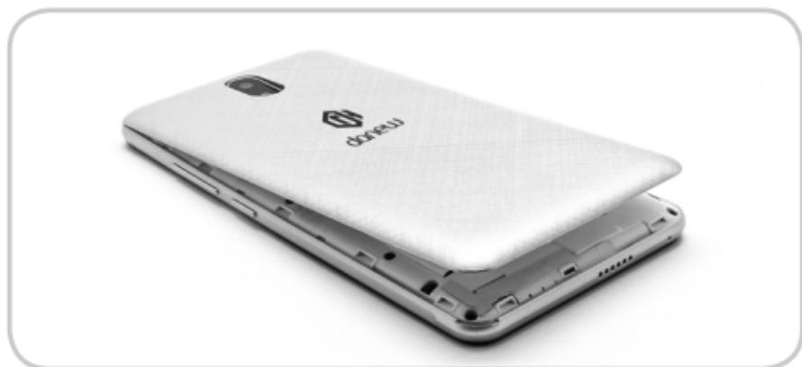
Heben Sie die rückseitige Abdeckung und entfernen Sie sie.
